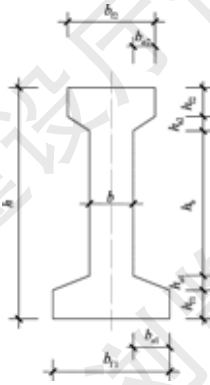
图 4.1.6 工型预制桩的结构尺寸图
